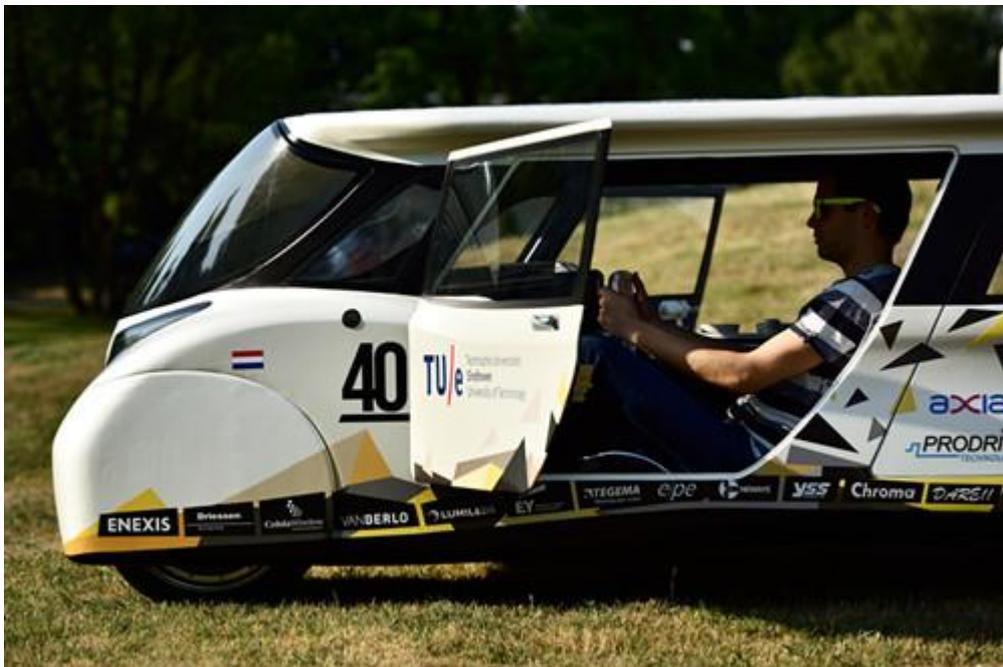
此外，为了优化 Stella Lux 汽车的空气动力学性能，汽车不仅有一个贯穿车身中心的隧道，车顶的两侧还被特意延长。
