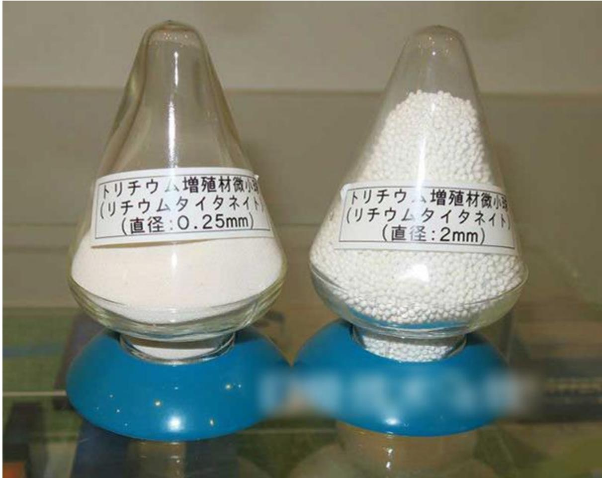
图 3: 包层中填充的  $\text{Li}_2\text{TiO}_3$  的制作示例 制作并测试了直径不同的材料。
