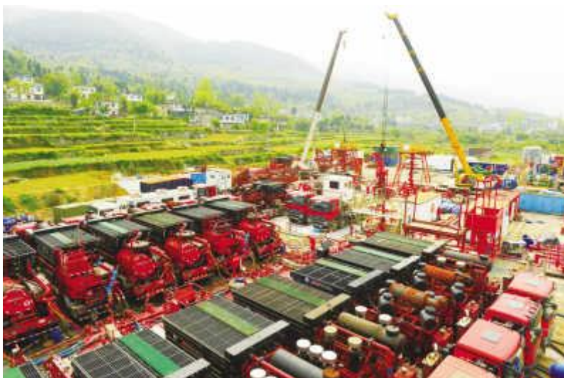
在国内首个大型页岩气田——涪陵页岩气田，中石化江汉石油工程运用自主研发的3000型压裂
