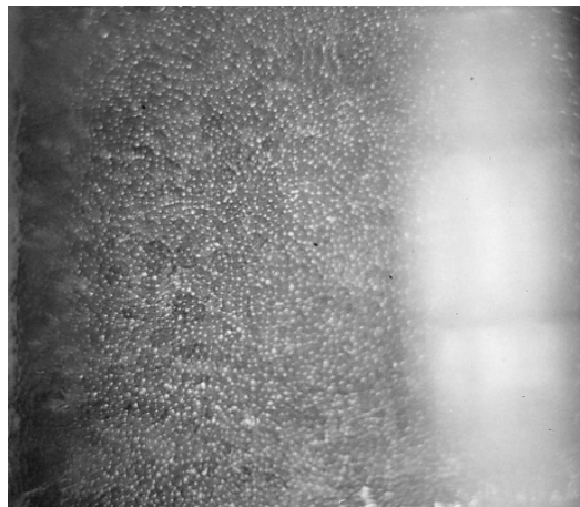
图 1-8 \text{CaCl}_2 溶液融化平板冰时形成的类似鲨鱼皮的融化表面
