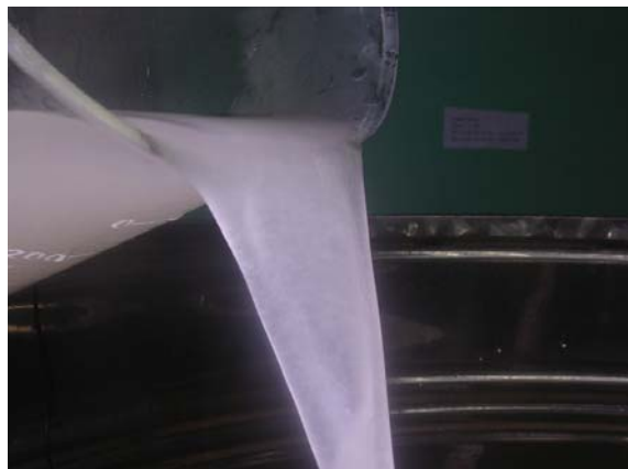
图 2-1 实验室制备的 TBAB 包络化合物浆 (CHS)
