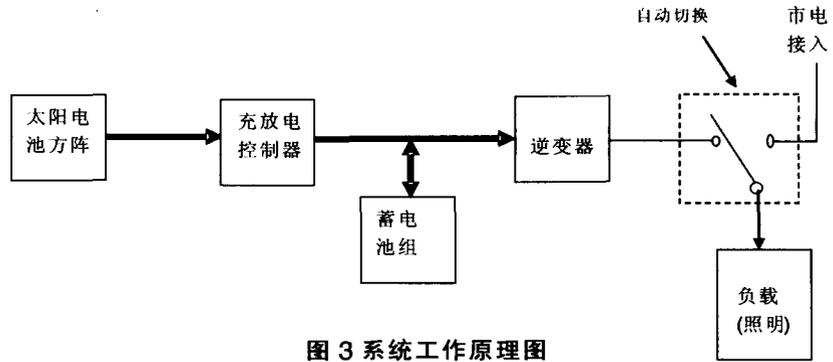
图3 系统工作原理图
