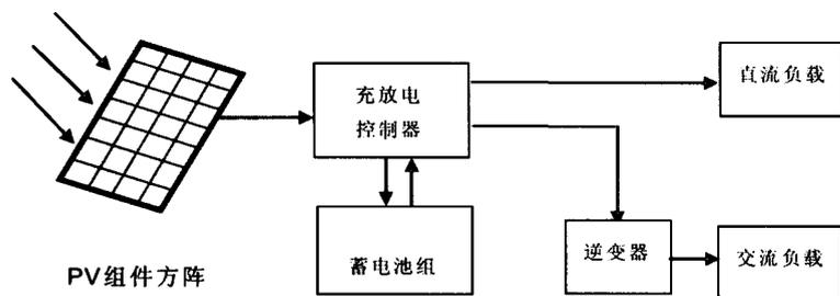
图1 可提供交流输出的离网型光伏系统
