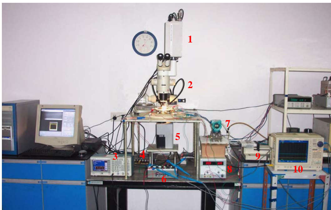
图 4-2 实验系统照片 (1) 高速相机, (2) 显微镜, (3) 脉冲函数发生器, (4) 同步器, (5) IR 红外成相机, (6) 标准电阻箱, (7) 压差变送器, (8) 直流电源, (9) 恒流泵, (10) 高速数据采集
