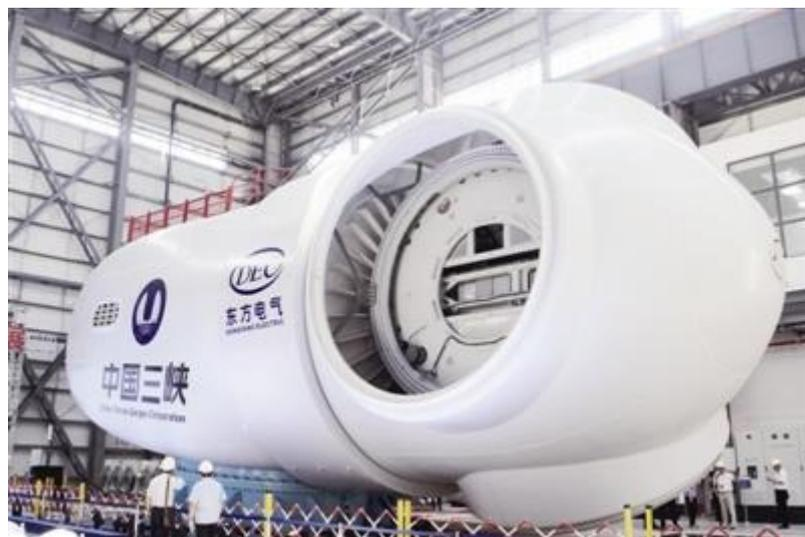
三峡集团联合开发，是针对中国福建、广东等海域 I 类风区设计的具备超强抗台风能力的海上风力发电机组，单机容量 10MW，叶轮直径 185 米，在年平均 10 米/秒的风速条件下，一台机组每年可以输送出 4000 万度清洁电能，可以减少燃煤消耗 13000 吨，二氧化碳排放 35000 吨。
