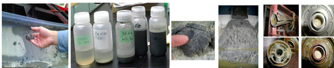
图 1 (a) 2013 年, 日本海洋天然气水合物开采每日产水出砂情况; (b) 2007 年, 加拿大陆域天然气水合物开采出砂情况图 [13]
