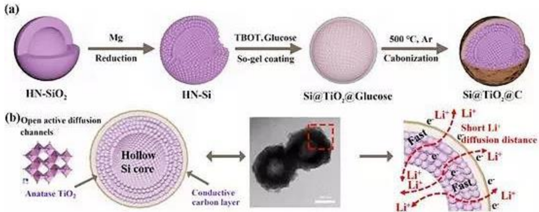
▲图 1 Si@TiO 2 @C 负极材料的(a)制备示意图和(b)结构示意图
