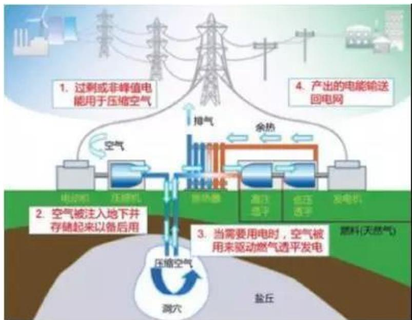
图3 传统压缩空气储能系统原理图
