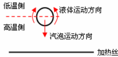
图 4-10 受热铂丝附近汽泡周围的 Marangoni 效应 [87]
