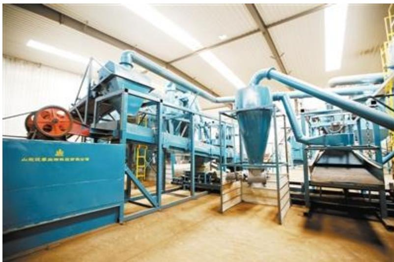
在中国最大的利用畜禽养殖废弃物和蔬菜秸秆制造生物有机肥基地——沃泰生物的车间里，几台大型专用粉碎机正轰鸣着将蔬菜秸秆粉碎，接下来它们将跟收集来的畜禽粪污混合搅拌在一起产生反应。在污染变身资源的道路上，这是秸秆与粪污的第一次相遇。
